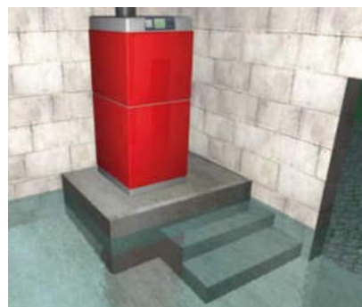
Mise hors d'eau par surélévation
