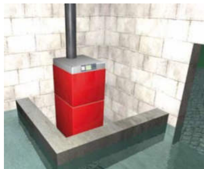
protection par disposition étanche
