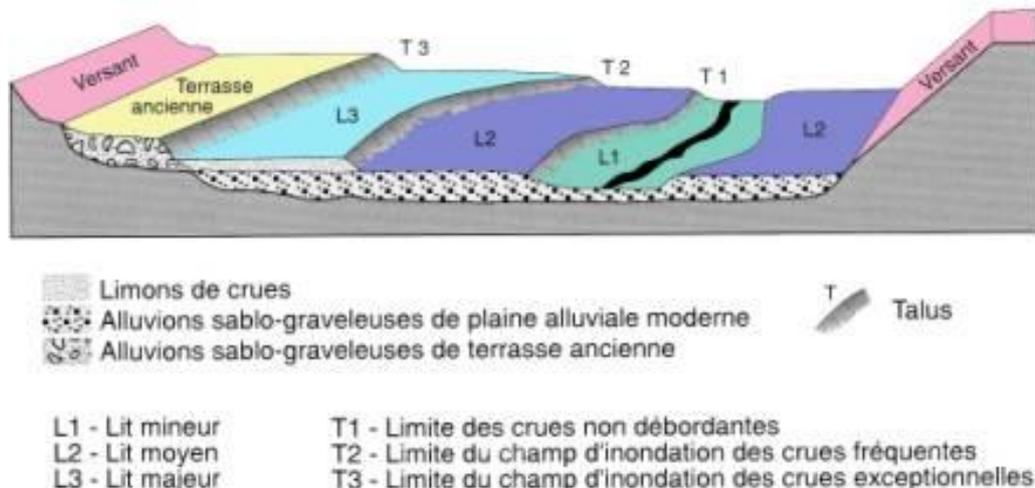
**Fig. 43. Coupe transversale d'une vallée mettant en relation la plaine alluviale, les terrasses anciennes et les versants**
