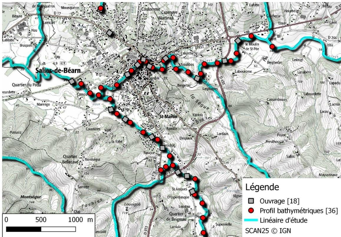
**Fig. 30. Emplacement des ouvrages et profils relevés**
