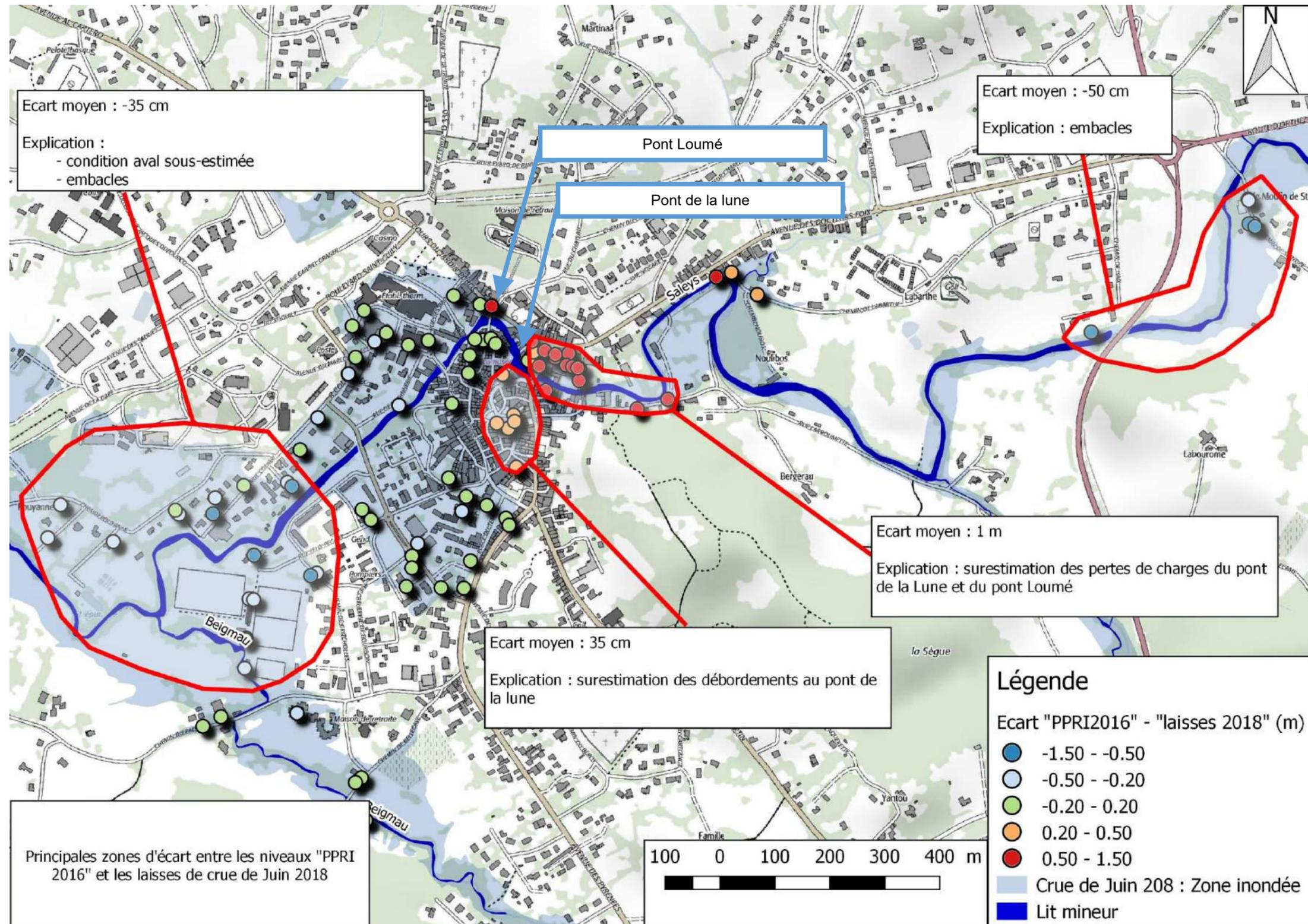
Fig. 5. Ecart entre les niveaux « PPRI 2016 » et les laisses de crue « juin 2018 »
