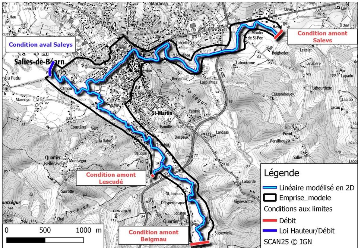
**Fig. 48. Conditions aux limites du modèle 2D**
