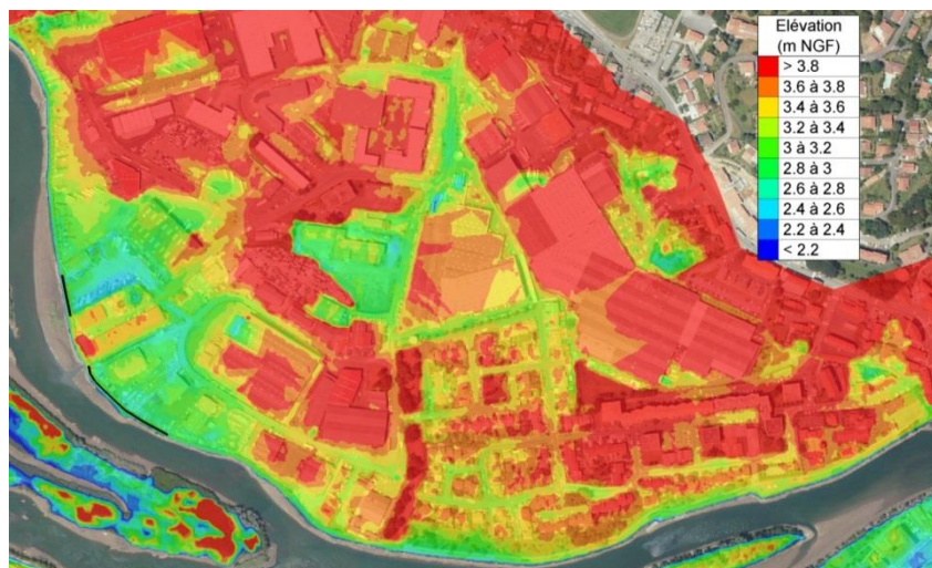
Figure 28 : Localisation des tronçons de la promenade des Joncaux surélevés par rapport au terrain naturel en arrière et considérés comme ayant un rôle de digue.
