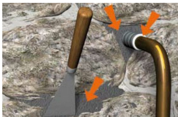
Situation après travaux de colmatage
