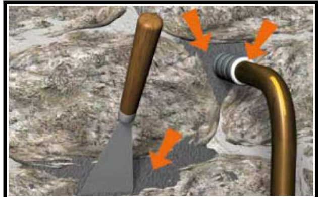
Situation après travaux de colmatage
