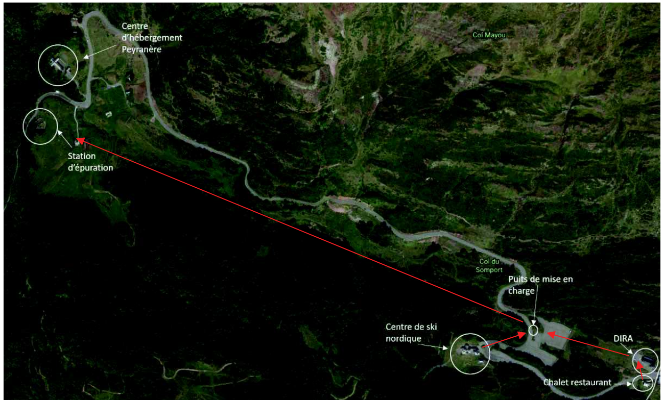
Le réseau d'assainissement sur le Somport
