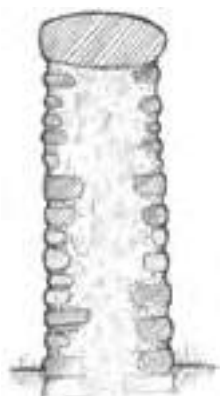
Mur en pierre, moellons et tout venant hourdé au mortier de chaux, couronnement de gros galets.
