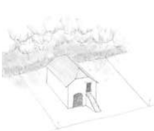
La grange est en appui sur la haie, un escalier en pierre facilite l'accès et le stockage des récoltes dans le fenil.
