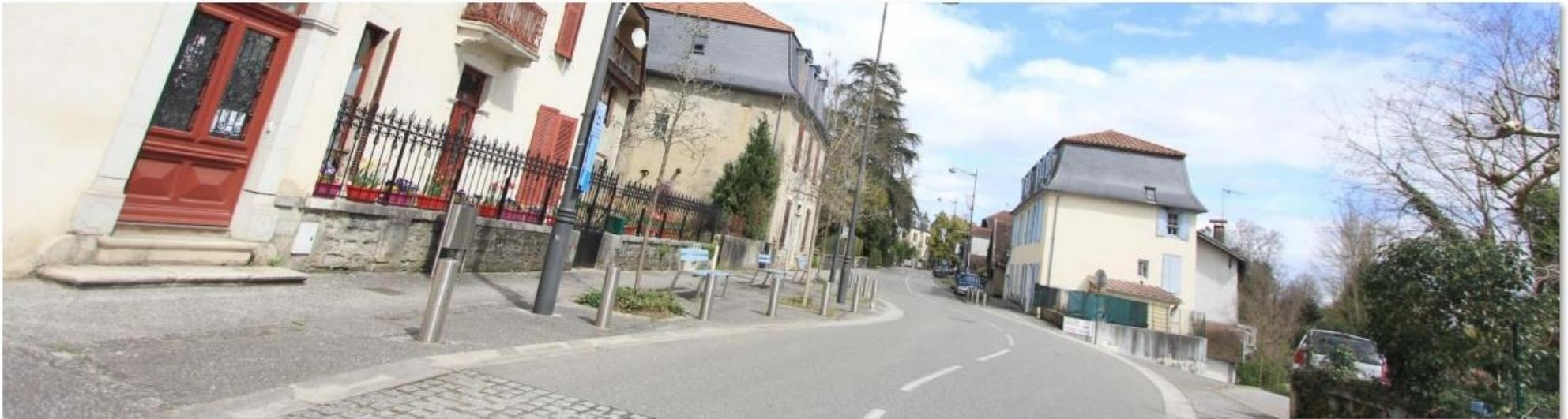
*Entrée de ville Nord Est, aménagement plus simple de seconde qualité : traversées en pierre, trottoir en béton désactivé et caniveau en béton. Cette gradation de l'aménagement permet de se repérer intuitivement.*
