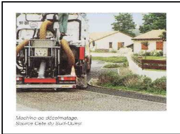
Machine de décolmatage Source CETE du Sud-Ouest
