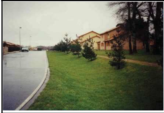
Noue le long d'une voirie créant un habitat aéré Source CETE du Sud-Ouest
