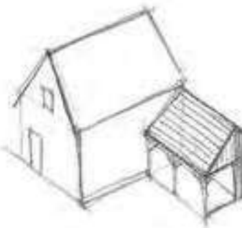
Abri léger orthogonal au bâti principal
