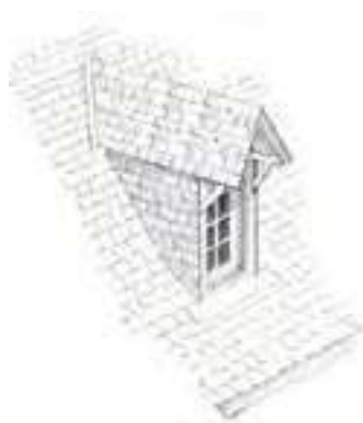
Lucarne à débord sur consoles.
