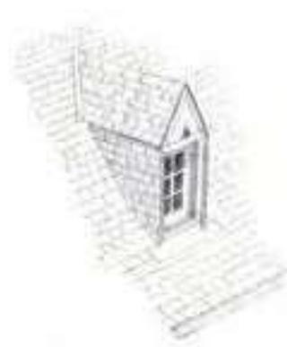
Lucarne en bâtière « jacobine ».
