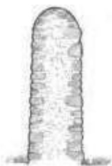
Mur en pierre, moellons et tout venant hourdé au mortier de chaux, couronnement arrondi.
