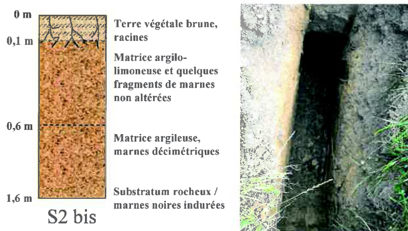
Figure 10 - Coupe et photographie du sondage S2 bis
