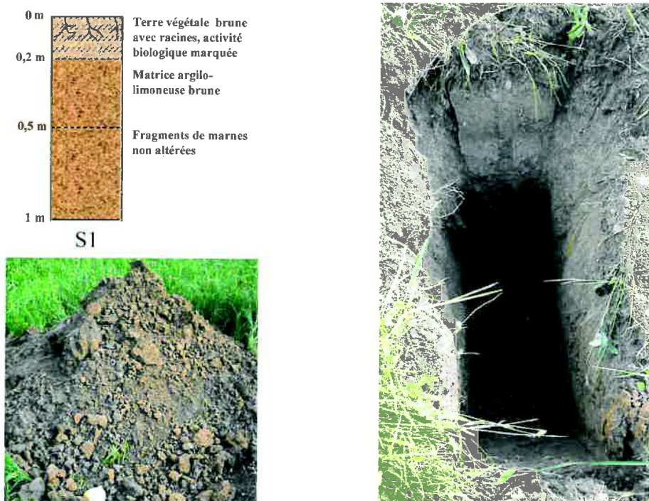
Figure 8 - Coupe et photographie du sondage S1
