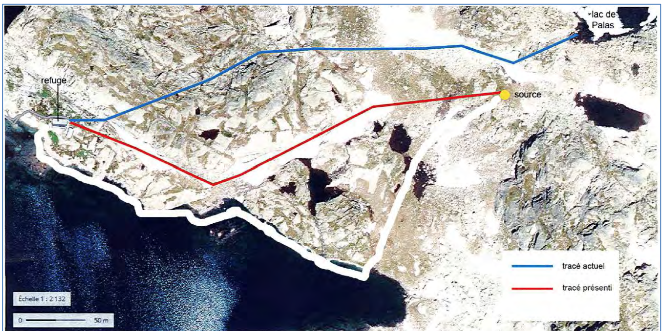
Carte n° 3 : Nouvelle canalisation pour l'eau potable
