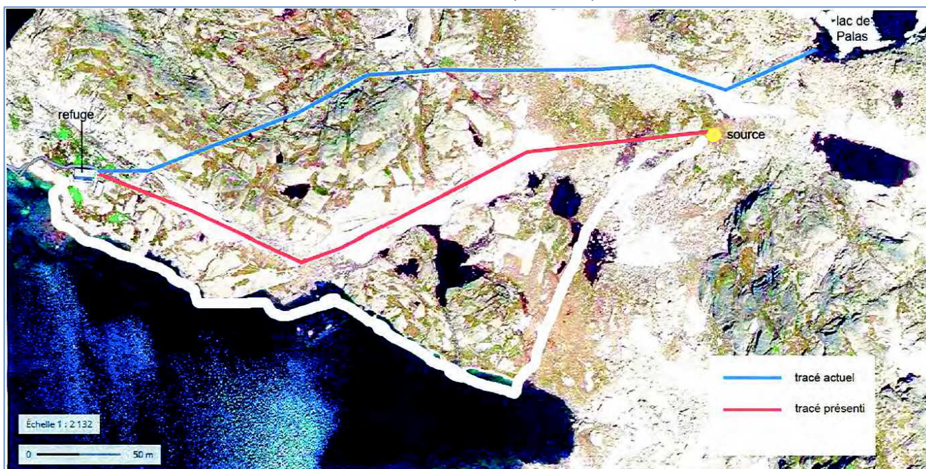
Carte n° 3 : Nouvelle canalisation pour l'eau potable
