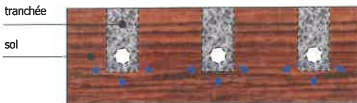
Infiltration dans le sous-sol
