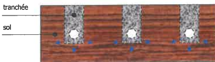
Infiltration dans le sous-sol
