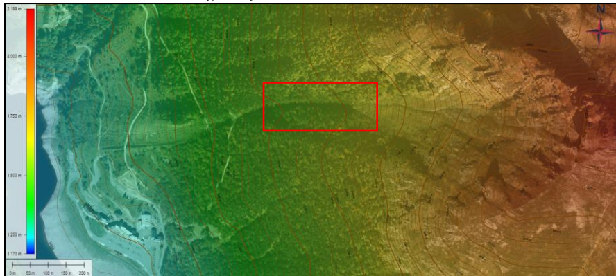
Figure 20 – Couverture topographique de la RGE alti avec courbes de niveau native et zone erronée évidente
