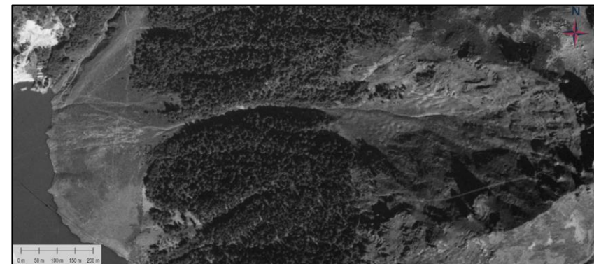
Figure 18 – Vue du couloir et notamment de chenaux d’écoulement torrentiels sur son cône aval sur le premier cliché aérien disponible de l’IGN en 1948 (source Géoportail “remonter le temps”)
