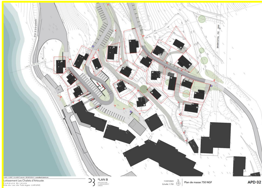
Figure 1 – Plan masse du projet “Les Chalets d’Artouste” [1] (nouveaux chalets sur les parcelles entourées en rouge)
