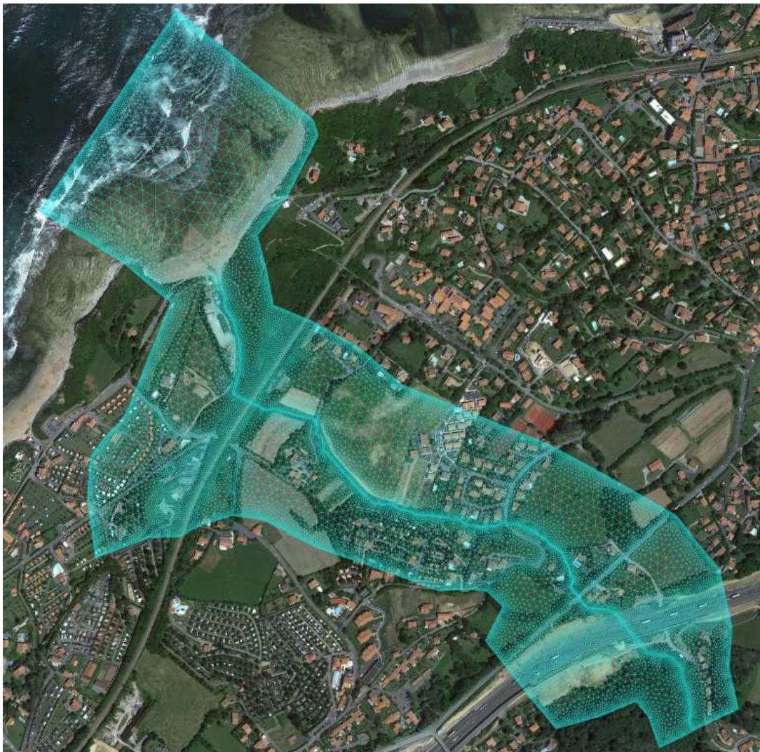
Figure 6 : Maillage du modèle hydraulique 2D du Baldareta
