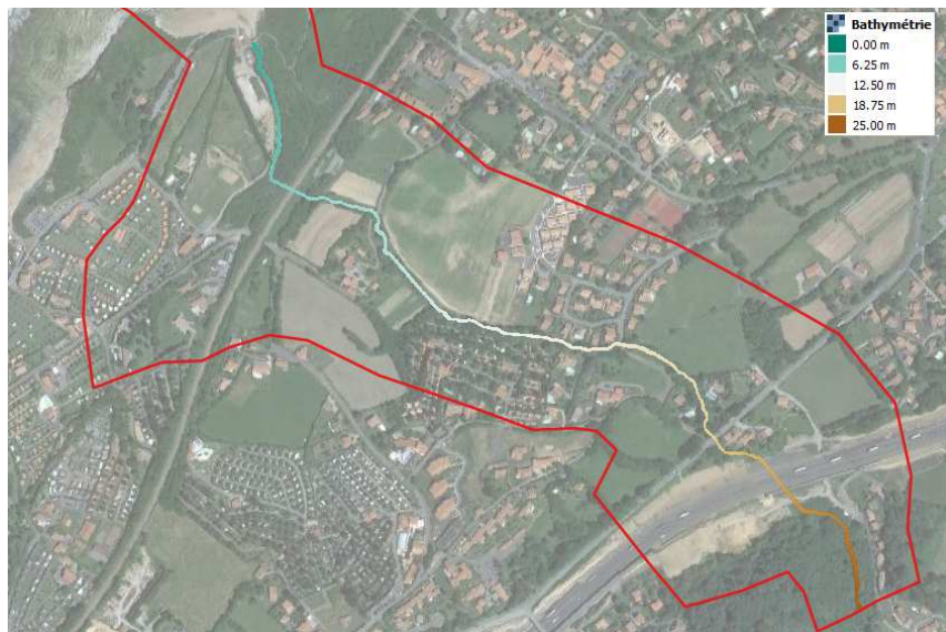
Figure 4 : Représentation de la bathymétrie du Baldareta, intégrée au modèle hydraulique 2D
