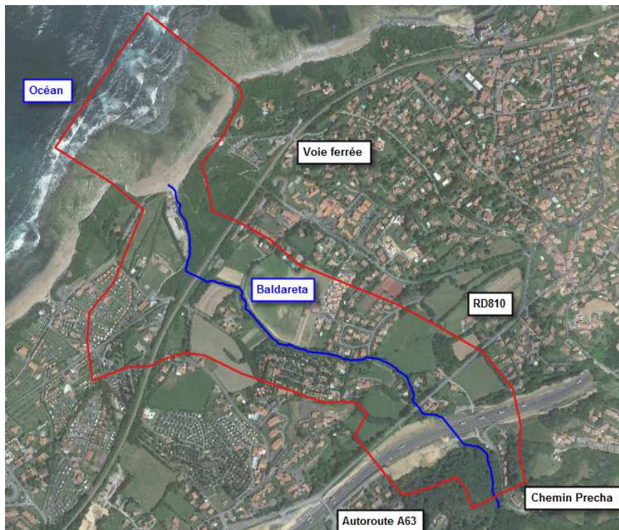
Figure 2 : Emprise du modèle TELEMAC-2D du Baldareta (en rouge)
